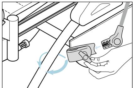
Зонт может быть установлен как с левой, так и с правой стороны корпуса. Сначала отсоедините фиксирующий зажим от зонта, отвинтите его и прикрепите к раме на нужной высоте. Затем вставьте зонт в фиксирующий зажим (слышимый щелчок встает на место). Угол наклона можно регулировать нажатием кнопки.
