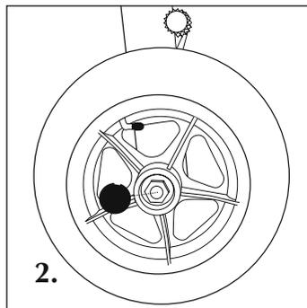
Снимите защитные колпачки в середине колес с помощью отвертки. Замените защитные колпачки в конце работы.
